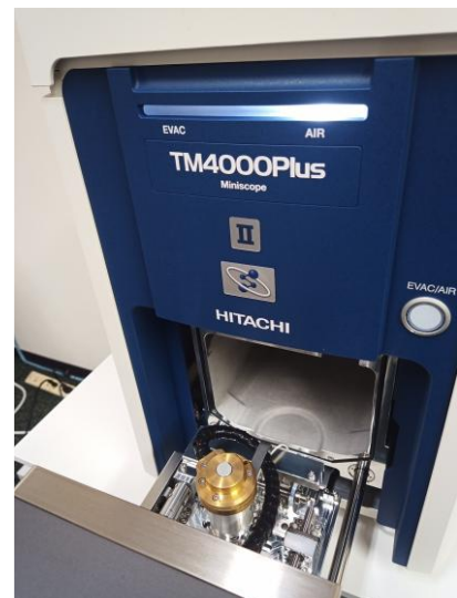
図: 走査型電子顕微鏡(日立 TM4000PlusII)に冷却ステージ MK-3 (DEBEN UK Ltd.)を装着
