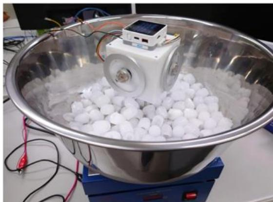
図 熱プローブによる温度計測実験（雰囲気：大気圧中、地球重力下）：1Uキューブサット相当の筐体の下部にある熱プローブで倒立するように、リアクションホイールで姿勢を保ちながら氷の温度計測を行った。姿勢の揺らぎによる温度変化の影響は小さく、小天体表層の温度測定を実現するための一歩を踏み出すことができた。
