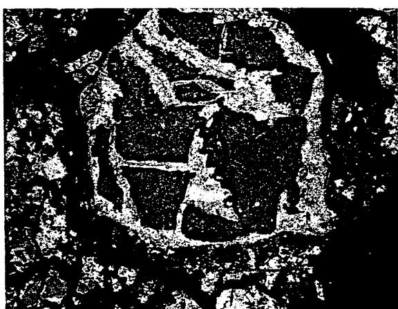
図1 水質変成で不規則に残った olivine (BEI、幅0.3mm)
