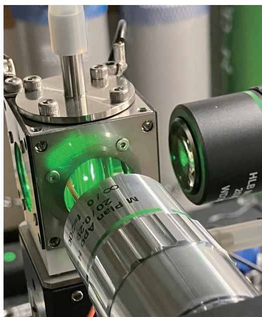
図1: 電気力学天秤の外観. 中央で発光して見える部分が, 電場によって浮遊している単一液滴である.
