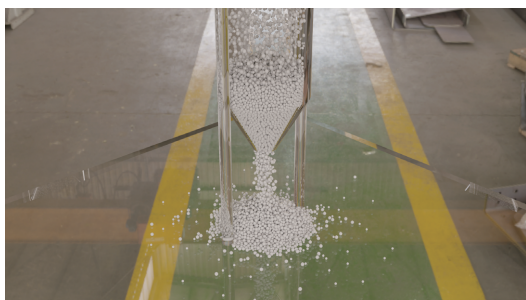
図1: LIGGGHTS [6] のサンプルスクリプトを実行して得られた結果をParaView [5] とBlender [3] を用いて作成した可視化の例. 背景画像としてPoly Haven [7] からダウンロードした画像を使用している.
