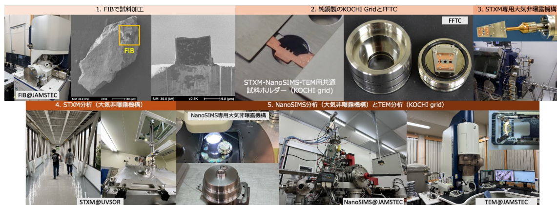
図5: (b) FIB-STXM-NanoSIMS-TEMのリンケージ分析.
