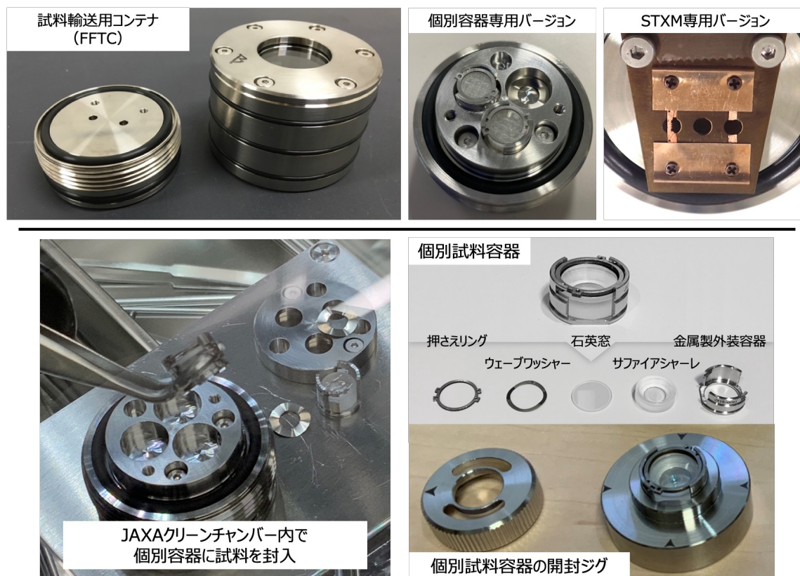
図2: はやぶさ2 試料の輸送容器(FFTC, 個別試料容器)。
