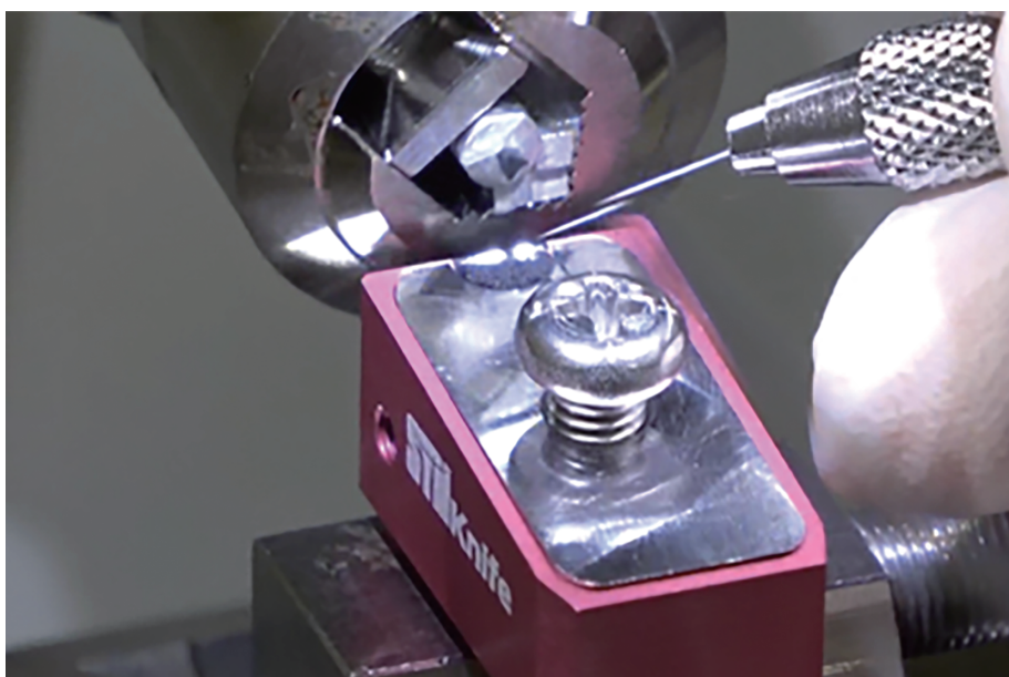
図2: 模擬試料を用いたウルトラマイクローム試料調製の様子. 手前の金属治具上に蓄積した切削片を回収し, bulk分析用に用いた.
