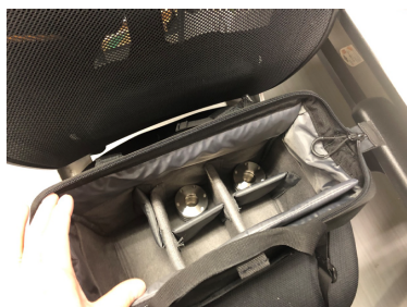
図3: ハンドキャリアによる試料運搬時の振動テスト.
