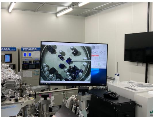
図1: (b)左: ハンドリングのリハーサルに用いたテスト試料(コバルトオケルマナイト,  $\text{Ca}_2\text{CoSi}_2\text{O}_7$ ), 右: クリーンチャンパー内で真空ピンセットとテスト試料を用いたリハーサル。
