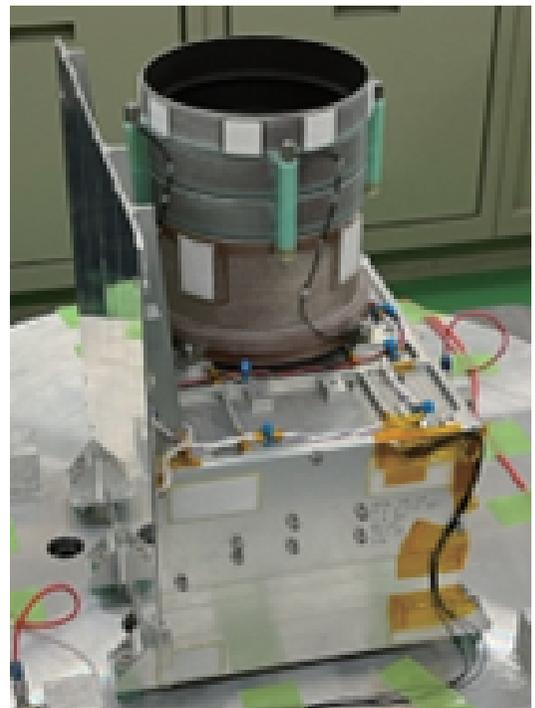
図7:振動試験中のHera搭載TIRIのフライトモデル。
