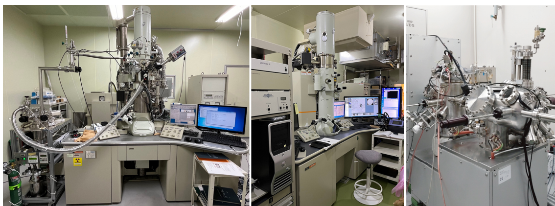
図2: 当グループが構築した3台の特徴的な顕微鏡:(左)超高真空極低温透過電子顕微鏡, (中)フルイド反応透過電子顕微鏡, (右)超高真空極低温原子間力顕微鏡.
