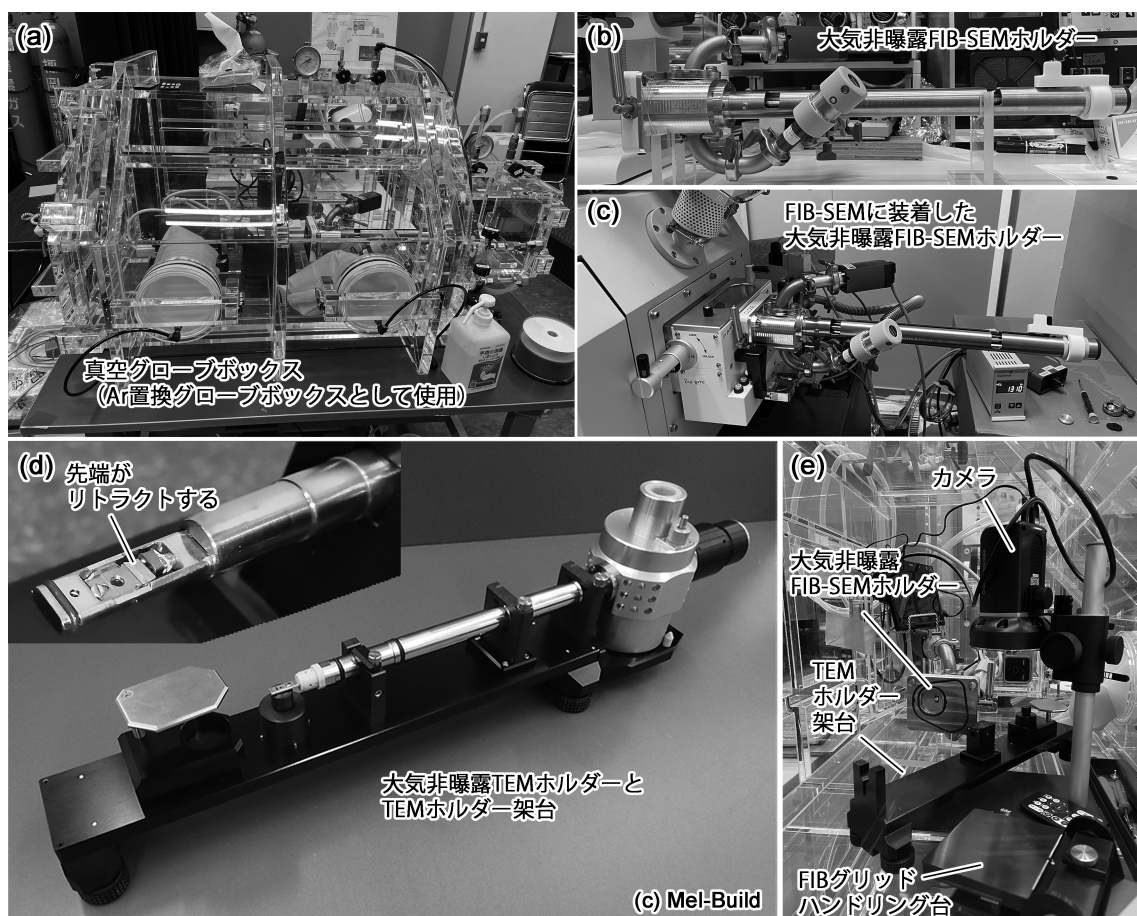
図2: 九州大総合理工学において使用した、大気非曝露(S)TEM試料作成・観察・分析のための装置。(a)真空グローブボックスをAr置換グローブボックスとして使用。(b)大気非曝露FIB-SEMホルダー全景。(c)同ホルダーをFIB-SEMに装着したところ。ホルダー全体写真はMel-Build社写真提供。(d)大気非曝露(S)TEMホルダーとホルダー架台。(e)グローブボックス内で大気非曝露FIB-SEMホルダーから大気非曝露(S)TEMホルダーに載せ替えてホルダーを取り出したあとの様子。
