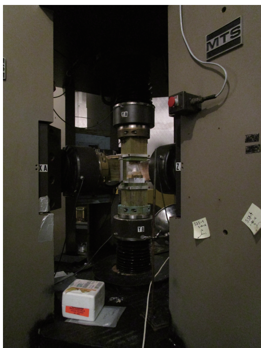
図2: IRLの大型三軸変形試験機。高さは4 m近くあるため、試料を設置するのも一苦労であった。
