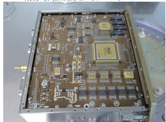
観測器制御・データ処理基板
