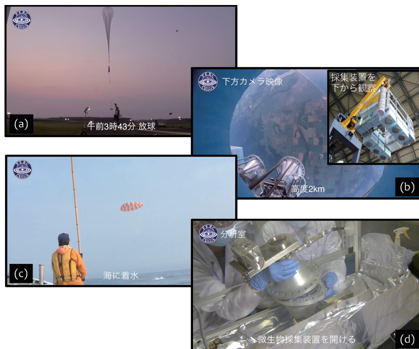
図2: 成層圏微生物採集実験の様子. (a)から(d)に向かって時系列で示している. パネル(b), (d)にPERCで新たに開発した降下式衝突型微生物採集装置が写っている.
