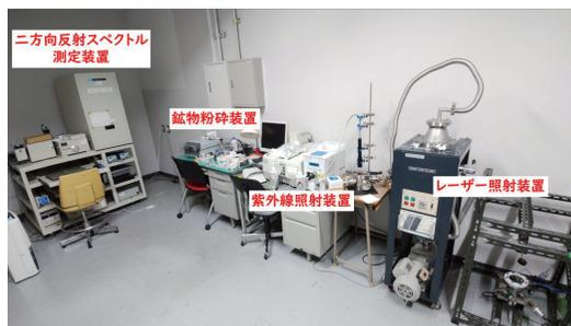
図3:宇宙風化作用実験設備。
