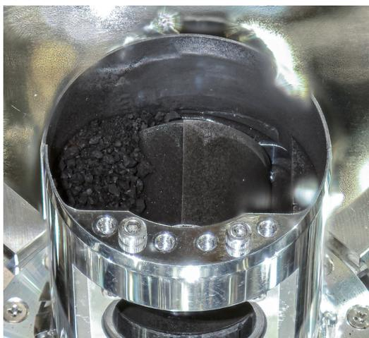
図6:CC3-2内で「はやぶさ2」サンプルキャッチャーA室を開封した様子。多数の黑色粒子が収められていた。このA室に収められているのは、小惑星リュウグウ表面で実施した1回目のタッチダウンで捕獲された試料である。キャッチャーの外径は48mm。
