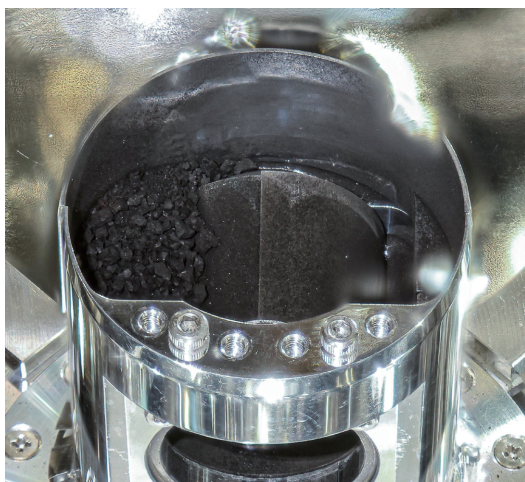
図6:CC3-2内で「はやぶさ2」サンプルキャッチャーA室を開封した様子。多数の黒色粒子が収められていた。このA室に収められているのは、小惑星リュウグウ表面で実施した1回目のタッチダウンで捕獲された試料である。キャッチャーの外径は48mm。
