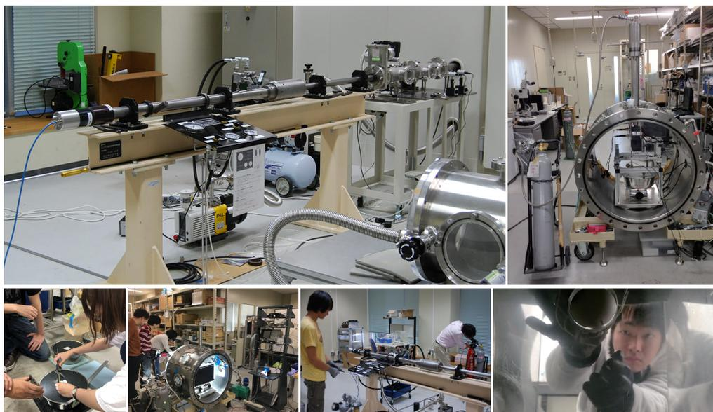
図1: 左上が横型二段式軽ガス銃, 右上が縦型一段式軽ガス銃. 下の写真は作業の様子.
