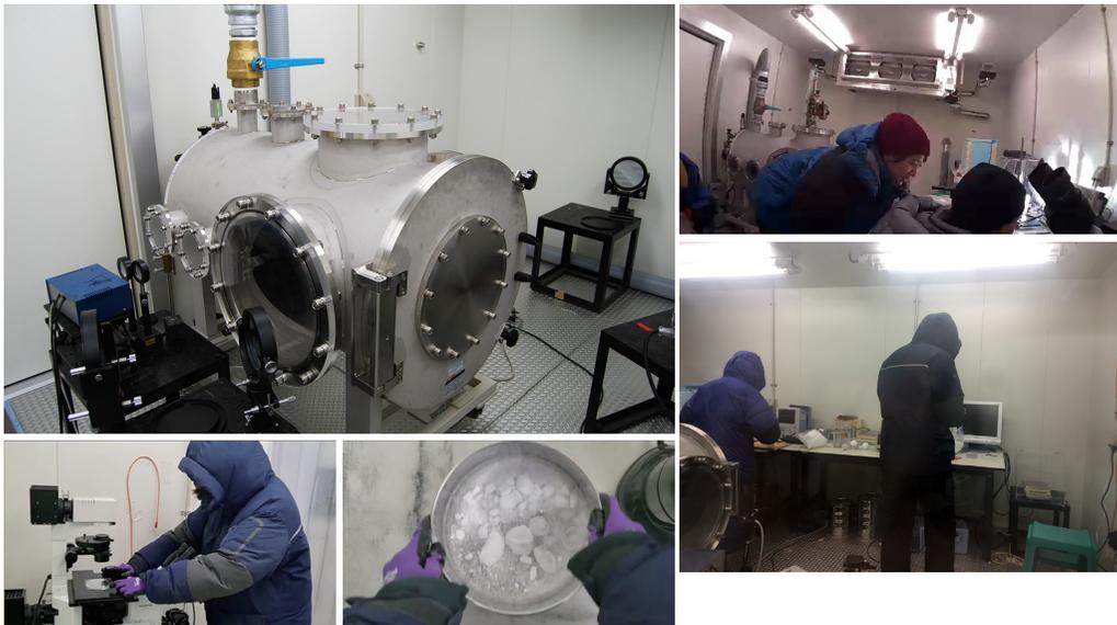
図2:左上が低温室内に設置された横型二段式軽ガス銃のチャンバー。他の写真は低温室内での作業の様子。
