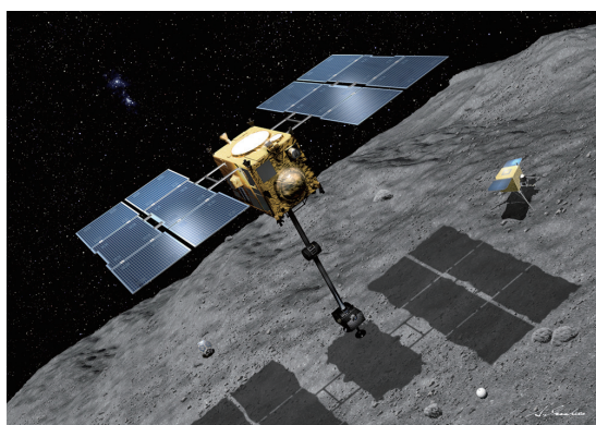
図2：マルコポーロミッションの想像図。大型の探査機で長い足の先にサンプルを撮る装置が付いている。表面には、着陸機(右)と小型ローバ(左)がある。この着陸機の議論が「はやぶさ2」のMASCOT に繋がった。なお、右下の白い物体はターゲットマーカである。(イラスト：池下章裕)
