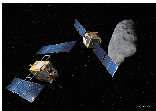
図1：「はやぶさ2」の初期の頃の提案。「はやぶさ2」に相当する探査機(左)が先に小惑星に到着して探査を行い、後から衝突機(右)と呼ばれる探査機が到着してそのまま小惑星に衝突するというミッションである。この衝突機が実際の「はやぶさ2」のSCIの元のアイデアである。なお、この時点での検討では、「はやぶさ2」に相当する探査機の方のハイゲインアンテナは1つのみとなっている。(イラスト：池下章裕)
