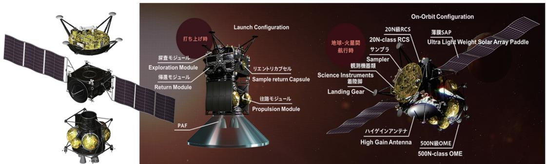
図2: 探査機の多段構成検討例.
