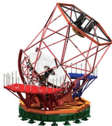
図11：3.8 m望遠鏡完成予想図。18枚の鏡を組み合わせる分割鏡方式で、独特な構造の軽量架台となっている。
