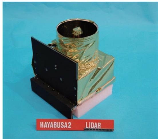
図2: LIDARフライトモデル外観。
