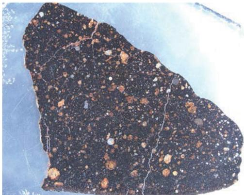
図1：Acfer 094隕石薄片の実体顕微鏡写真。白から明るい褐色の様々な形をした包有物がコンドルールとCAI。殆ど不透明の黒い部分は数ミクロン以下の微粒子が集積しているマトリックス。大小の割れ目に添って細粒の風化生成物が沈着し、コンドルールが褐色がかって見える傾向がある。写真の横幅は約15mm。
