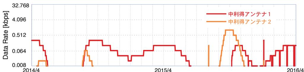
図6：金星軌道再投入時における白田宇宙空間観測所のテレメトリ回線予測。
