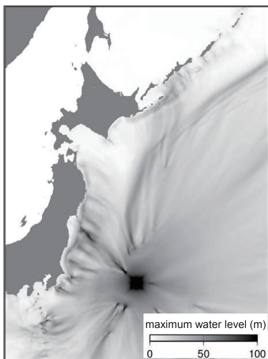
図7：直径500mの天体が水深5000m地点に衝突した際に発生する津波の最大水位分布(m)。
