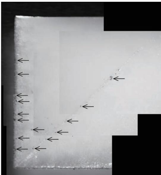
図8：キャッチャー A室内部を搔いたテフロンヘラの光学顕微鏡写真のモザイク画像。多数の粒子が主にヘラの縁辺部・稜部に捕獲されているのが確認できる(矢印)。ヘラの縦の長さが5mm。
