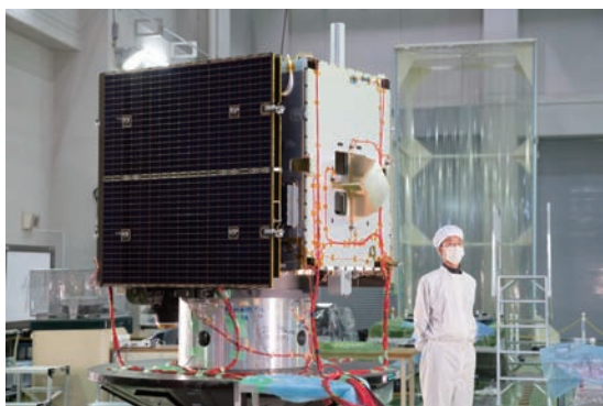
図5：システム機械環境サーベイ試験に臨むはやぶさ2 (©JAXA).
