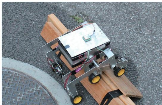
図5：段差走破試験。
