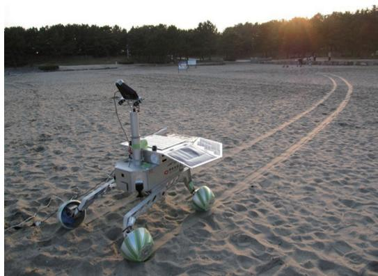
図1: 遠隔操縦型科学観測ローバ。
