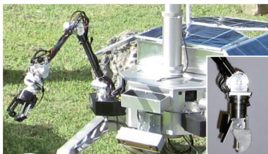
図4：USM駆動型5DOFマニピュレータ。
