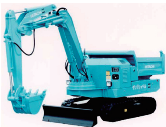
図1: MOVE のベースマシンMPX10. アームを除いた本体全長はおよそ3.2m. 日立建機株式会社のホームページから転載(現在は閉鎖).
