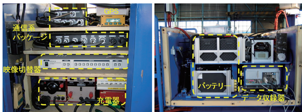
図3：断熱ボックス内に収められた機器類。MOVEの左と右から見た状態。
