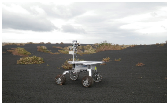
(c)2週間にわたる長期野外運用試験に挑んだ明治大学Micro6-3号機(2011年)
