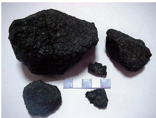
図1：NWA 2737シャシナイトの外観写真。カンラン岩にもかかわらず真っ黒な外観を示している。画面中央付近の白黒の紙片がスケール=横幅5センチメートル。画像提供：Bruno Fectay, Carine Bidaut
