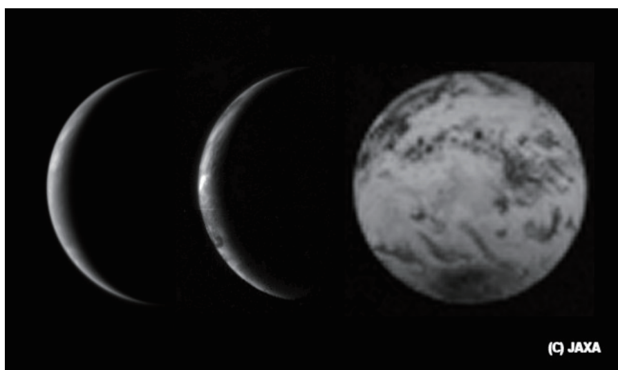
図3: 撮像された地球画像((C) JAXA). UVI(左), IR1(中), LIR(右)の画像を地球中心にトリミングしたものである。UVI, IR1画像は日照面のみが, LIR画像には夜側の大気写っている。
