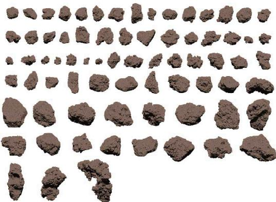
図2：CTイメージから再構築した74個の月面表層土粒子3次元画像(No.60501,  $105 \sim 250 \mu\text{m}$ )
