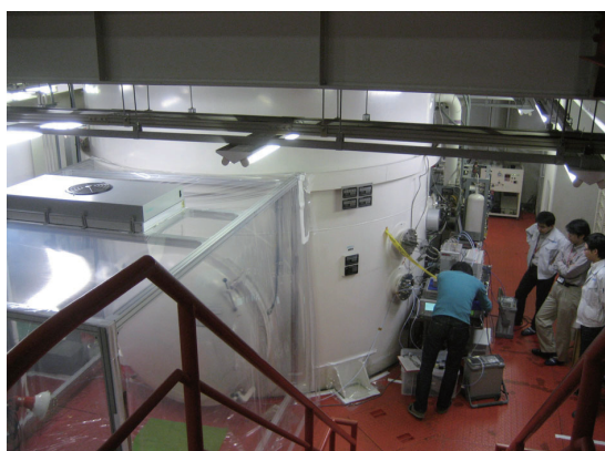
図10：熱真空試験中のUSO性能評価試験
