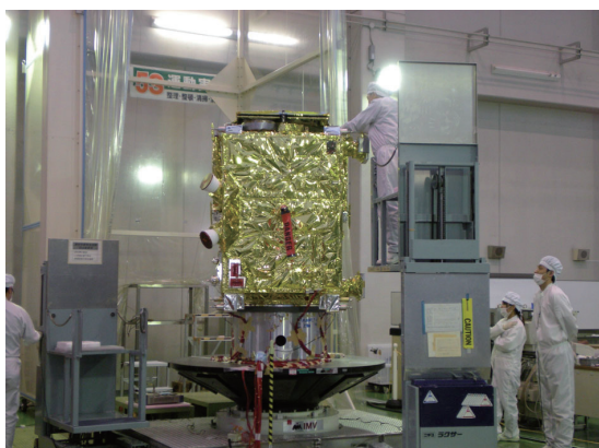
図7：垂直方向の加振
