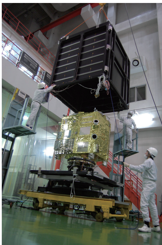
図8：IRパネルの取り付け
