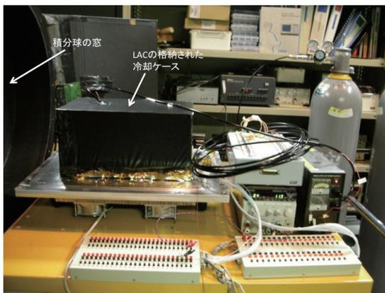
図3：積分球を用いた感度校正試験の様子
