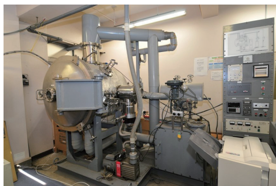
写真8：鯨観測衛星プロジェクトから譲渡された熱真空チャンバー。
