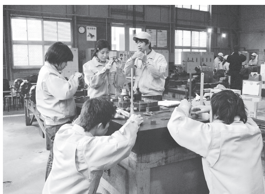
図5：工作技術センターでの「金属工作」実習。手前：けがき作業、奥：旋盤作業。
