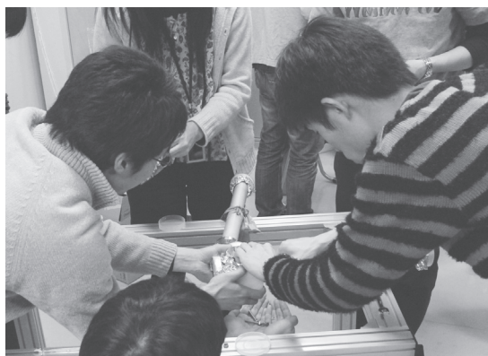
図4：「真空技術」実習。配管を組み立てる。
