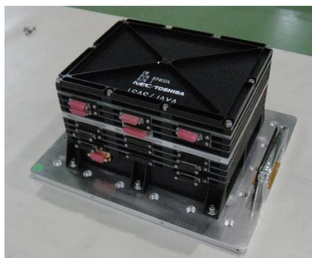
図2：組立を待つDE(Digital Electronics)部
