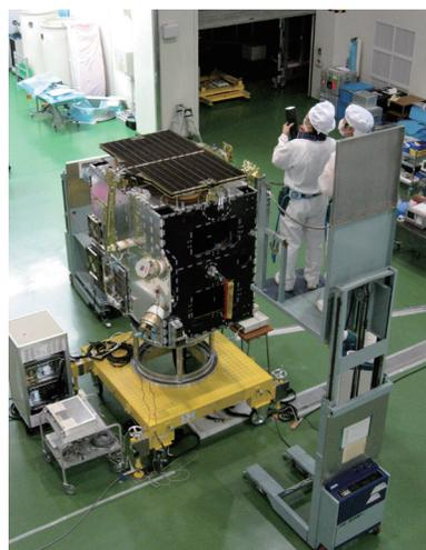
図4：衛星の姿勢を計測する太陽センサーの試験の様子
