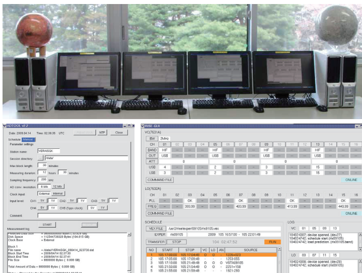
図5：VLBI観測データ記録遠隔操作システム。上：遠隔操作室，左下：SRTPDデータ収集制御画面，右下：ビデオコンバータとローカル発振器の制御画面。
