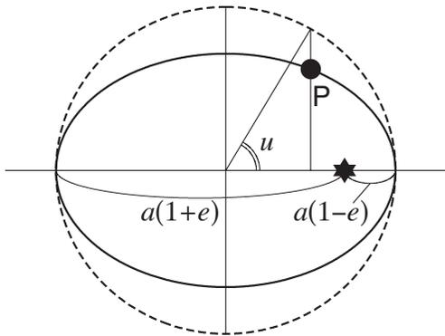
図2：惑星の位置Pに対する離心近点角 $u$ . 平均近点角 $l$ は惑星の軌道長半径を直径とする円上等速運動すると仮定したときの角速度である.
