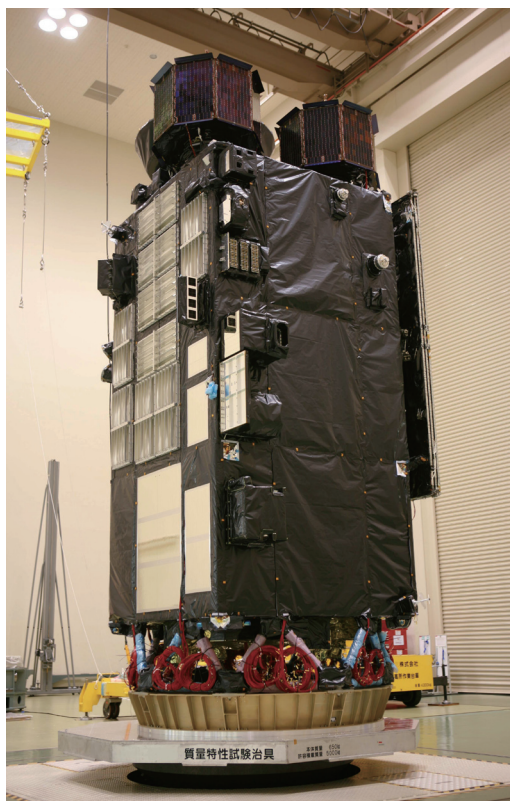
図1：フルコンフィギュレーションのSELENE（質量特性計測時）。打上げ時の質量とモーメントを計測している。子衛星2機（リレー衛星、VRAD衛星）も衛星上部に搭載されている。
