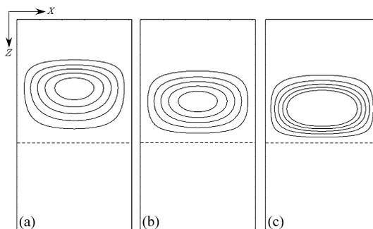
図7：表2のマントル温度1600 Kの場合に対応する流れ線．プレート年代は(a) 250, (b) 500, (c) 750 Myrである．枠の深さは1200 kmまでであり，幅は仮定した擾乱の水平波長，(a) 610, (b) 610, (c) 600 kmである．深さ700 kmにおける上下マントルの境界は破線で示している．等値線間隔は流れ関数の絶対値によらず5段階としている．
