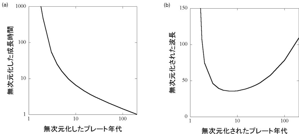
図5：粘性率一定での計算結果。(a) 縦軸は無次元化した成長時間、横軸は無次元化したプレート年代を表す。(b) 縦軸は無次元化した波長、横軸は無次元化したプレート年代を表す。
