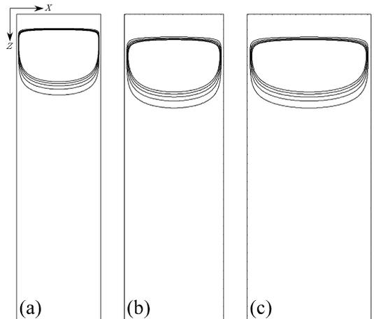
図3：図1(b)の成長する擾乱(太い実線)に対応する流線。枠の深さは上下マントルの境界、660 kmまでであり、幅は仮定した擾乱の水平波長、(a) 170, (b) 200, (c) 250 kmである。等値線間隔は流線関数の絶対値によらず5段階としている。
