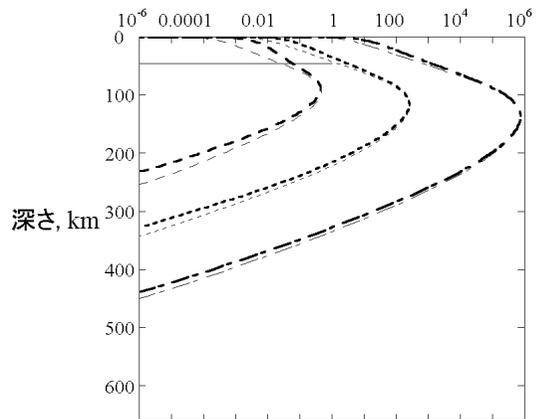
図2：プレート年代10 Myrにデルタ関数的に与えた擾乱(実線)の時間発展。長い破線が30 Myr、短い破線が50 Myr、一点鎖線が70 Myrでの擾乱を表している。太線は(33)式による時間積分を、細線は時刻を固定して計算した固有ベクトルを示している。細線の振幅は、太線にピーク高が一致するように適宜調整している。
