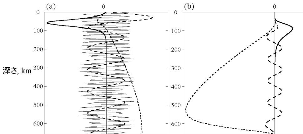
図1：プレート年代が10 Myr、水平方向の波長が150 kmの地球マントルについての計算例。(a) 温度擾乱の固有ベクトル。(b) (a)に対応する流線関数の固有ベクトル。代表的な固有ベクトルのみを表示している。太い実線、細い実線、長い破線、短い破線の成長時間はそれぞれ8.7、-0.26、-6.8、および-18 Myrである。太い実線の固有ベクトルのみが成長し、他は全て減衰する
