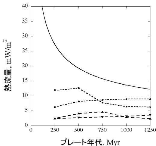
図6：金星表面熱流量に対するsecondary convectionの熱的寄与．実線は半無限媒質の冷却モデルに基づく金星リソスフェアの熱流量[1]を，破線は(35)式から見積もられるsecondary convectionの熱的寄与を表している．長い破線はマントル温度1500 Kの場合，短い破線は1600 Kの場合で，上向きの三角はsecondary convectionの範囲を擾乱のピークの1/10までとした場合，下向きの三角は1/100までとした場合である．
