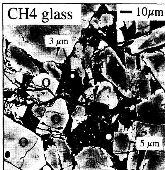
図2 Semarkona隕石コンドールCH4のガラス部分の電子顕微鏡写真[5]約0.8mm径のコンドールの一部。図中の○はオリビン、Pは輝石、暗い部分がAlに富むガラス。ガラス中の明るい針状の結晶は輝石の微結晶。白い円形の印は実際のSIMS測定の一次イオン径の大きさと場所を示している。
