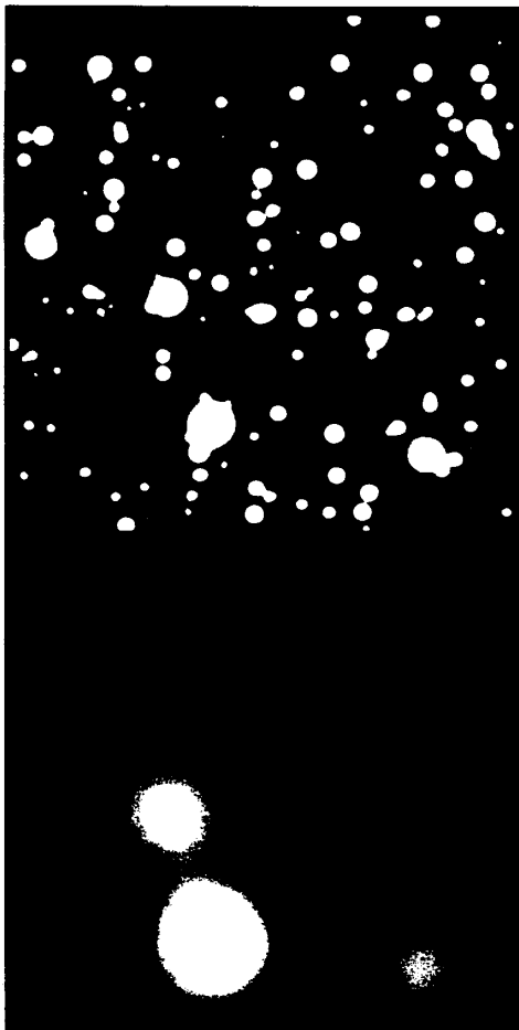
図4 気流の乱れによる星像の広がりシミュレーション[13]。下の画像が典型的な日本の空、上が典型的なハワイ・マウナケア山頂の空。
